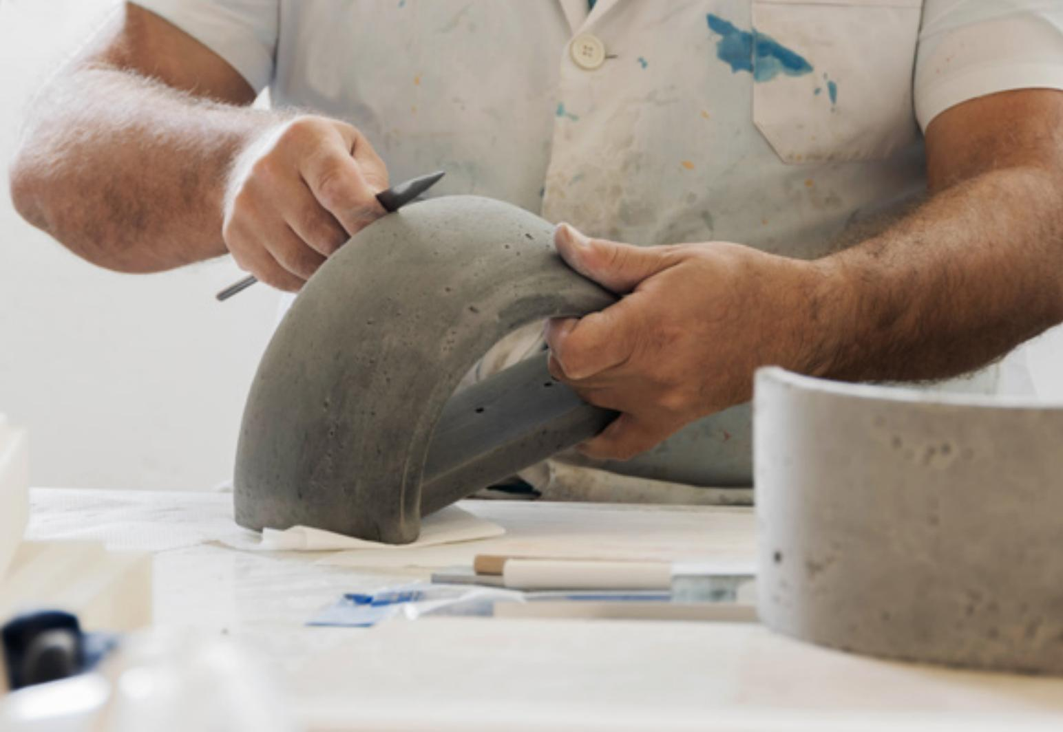
Il processo di creazione del **CONCRETE INDOOR 9010** inizia con il controllo e la selezione di ogni stampo affinché sia pronto all'unione dei componenti.
